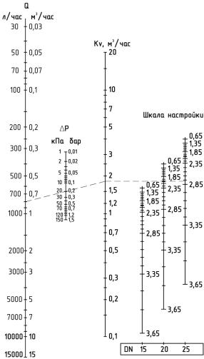
**Пример**: При известном расходе Q = 800 л/ч (0,8 м3/ч) и требуемом перепаде давления на клапане  $\Delta P = 20$  кПа (0,2 бар) проводим отрезок между двумя точками до значения Кv (см. номограмму), а от значения Kv - горизонтальную линию через все диаметры клапанов, на основании которой по шкалам настройки(справа) выбираем подходящий клапан.
