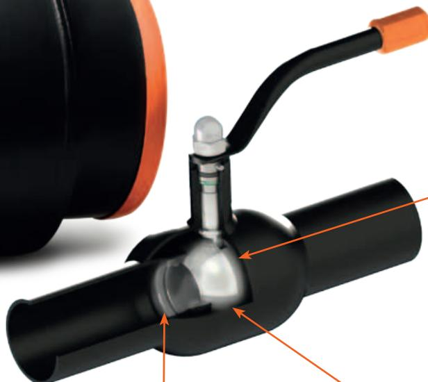
Полированный шар из нержавеющей стали, шероховатость поверхности не превышает 0,1 мкм. Острые кромки на шаре в местах работы седловых уплотнений скруглены радиусом. Дополнительно шар покрыт смазкой, что позволяет снизить трение, и, соответственно, износ кольцевых уплотнений, и увеличить срок эксплуатации крана.
