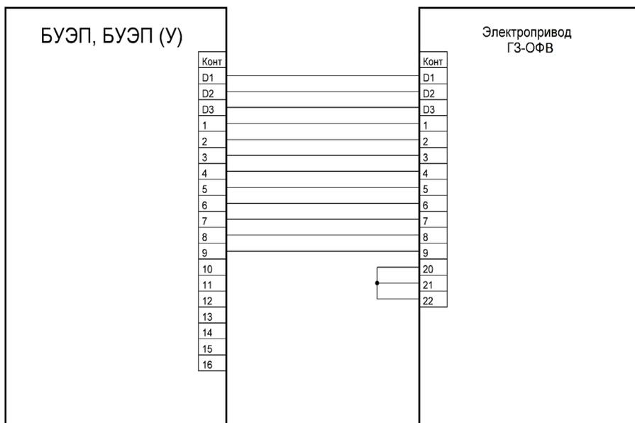
Рис.5 Блок-схема подключения БУЭП к электроприводу (к рис.4(2))
