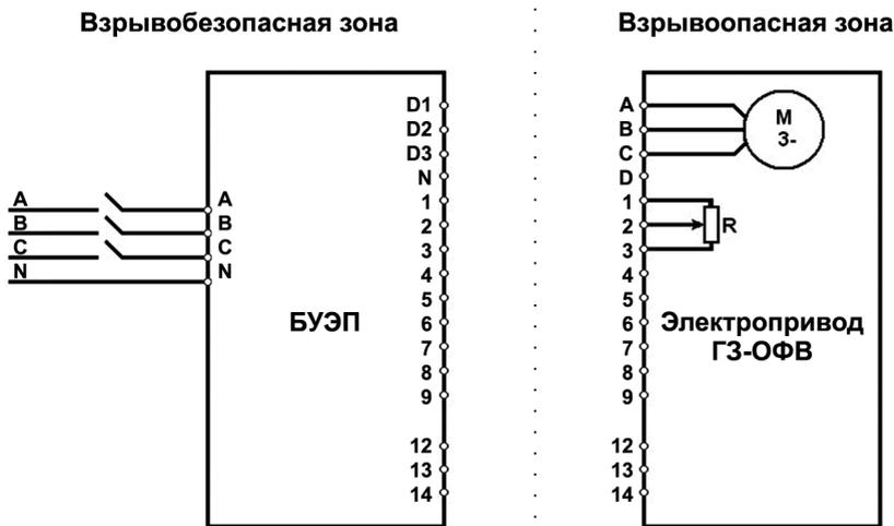
Рис.5 Блок-схема подключения БУЭП к электроприводу (к рис.4(1))
