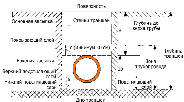
Рис. 3 Устройство траншеи
