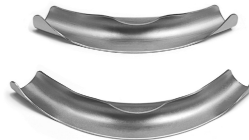
Рис. 50 Фиксаторы поворота (водоснабжение / отопление) (3-4 х ø) – 90° или 45° для изгиба труб ø 16-32
