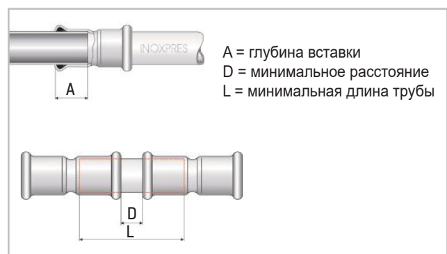
Рис. 27. Глубина вставки и минимальные размеры.
