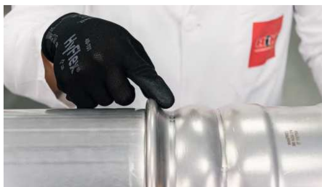
Рис. 36. Визуальный осмотр места прессования Oversize.
