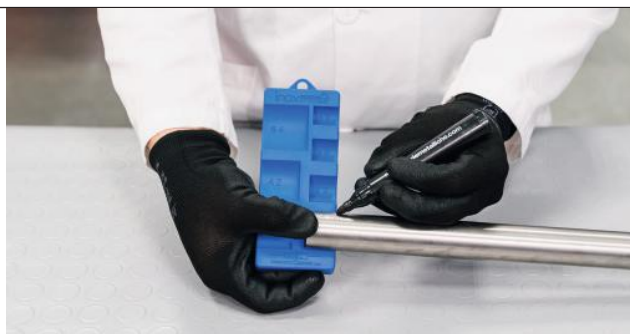
Рис. 28. Маркировка глубины вставки.
