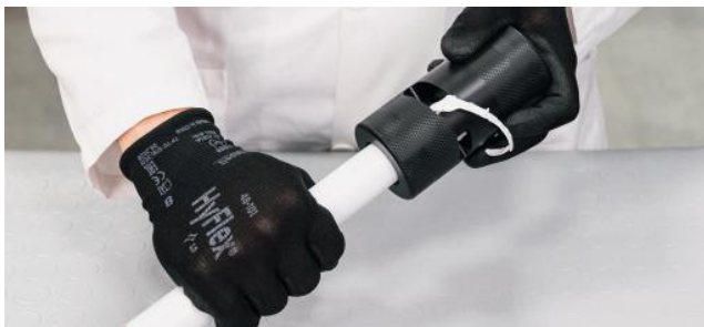
Рис. 29. Резка (труба steelPRES в изоляции из полипропилена).
